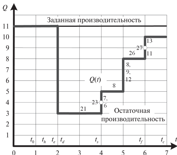
Рис. 3. График восстановления сети, изображенной на рис. 1.
